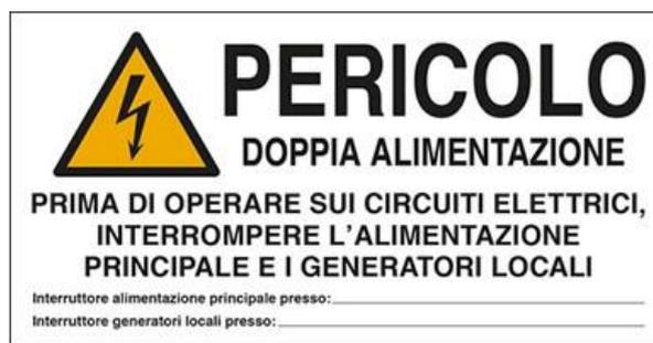
*Figura 45 – Cartello monitor da installarsi in corrispondenza della protezione della linea alla colonnina di ricarica auto elettrica*
